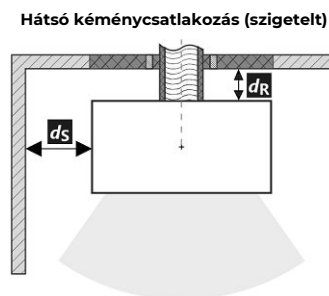
A füstcső áthaladása éghető anyagból készült falon
